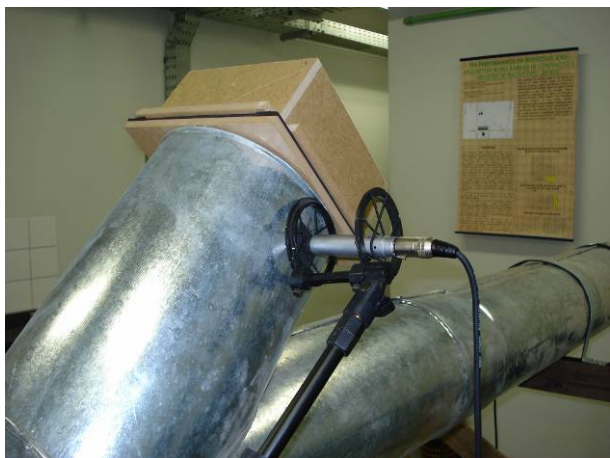
Figura 3.1 – Detalhe da montagem experimental para a realização da identificação do caminho eletroacústico utilizando-se filtragem adaptativa.
